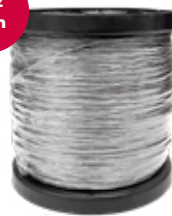
Aitavaijeri, 1,5 mm. Rullassa 1000 m. Vetolujuus 200 kg. Rullan paino 11,75 kg
